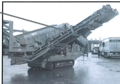
Convoyeur de granulométrie moyenne en position de travail
