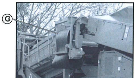
Convoyeur en position de transport
