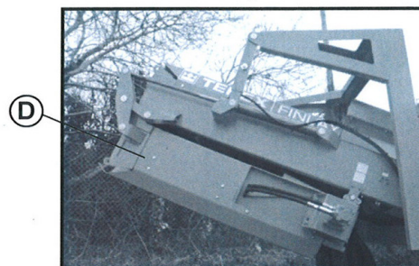
Convoyeur de surclassés en position de transport
