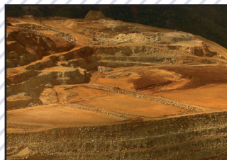
Photo 6 - Plateforme de verse lissée à la lame du bull
