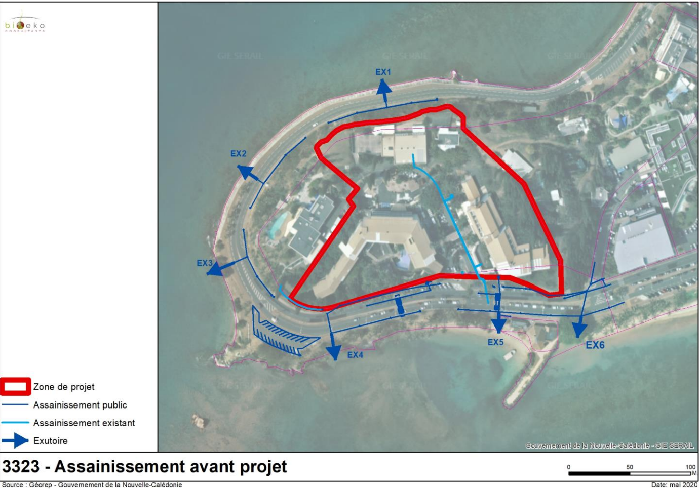
Figure 30 : Implantation du réseau d’eaux pluviales public en façade de la zone de projet (source : Etat des lieux, THEOME)
