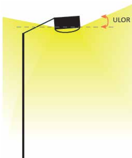
Luminaire émettant vers le ciel (à éviter)
