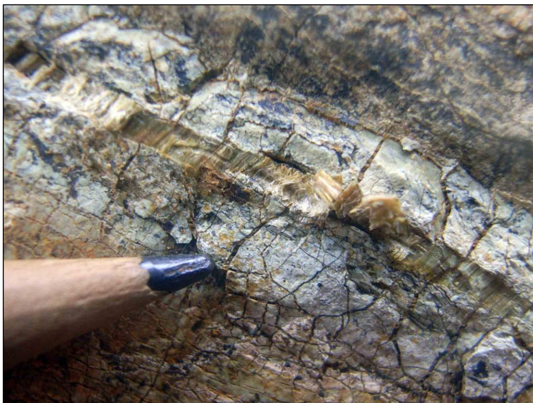
Figure 9 : Veinule fibreuse à cristallisations subperpendiculaires aux épontes et débit en peluches (071)
