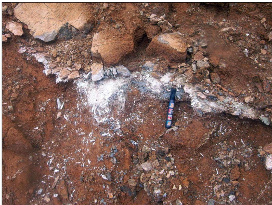
Figure 3 : Remplissage fibro-lamellaire altéré d'une fracture affleurant perpendiculairement au talus (010)
