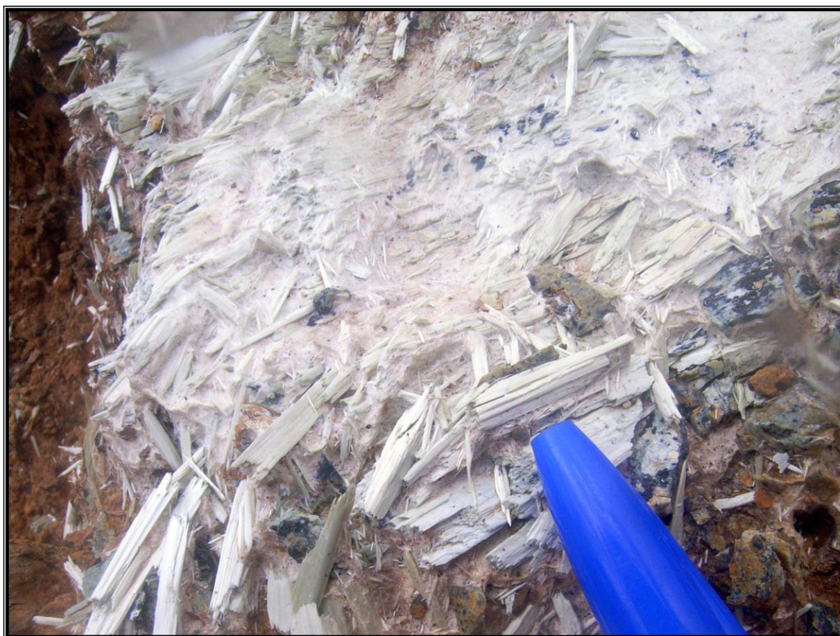
Amas fibreux et lattes résiduelles issus de l'altération d'une fracture serpentineuse à remplissage fibro-lamellaire
