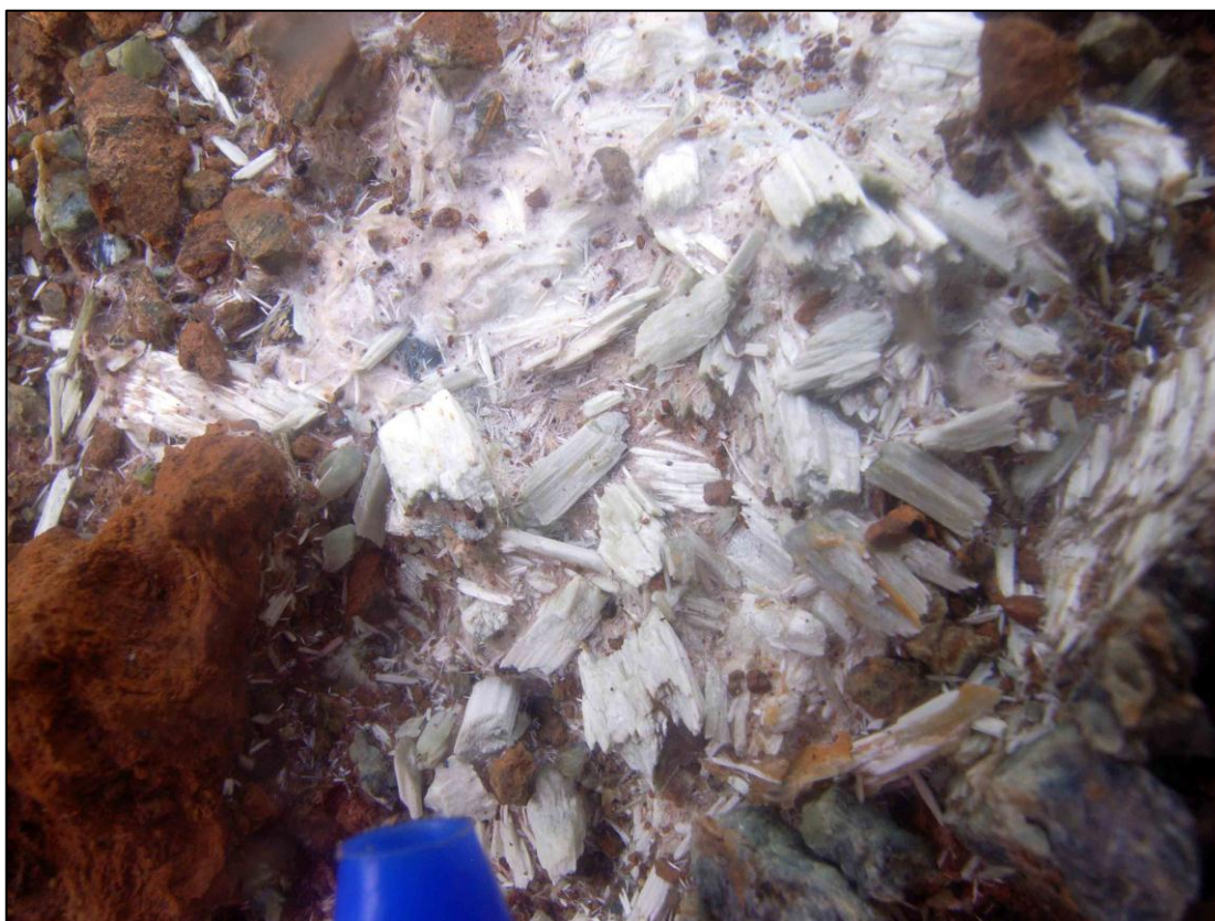
Figure 5 : Altération d'une occurrence fibro-lamellaire en amas fibreux et lattes résiduelles (009)
