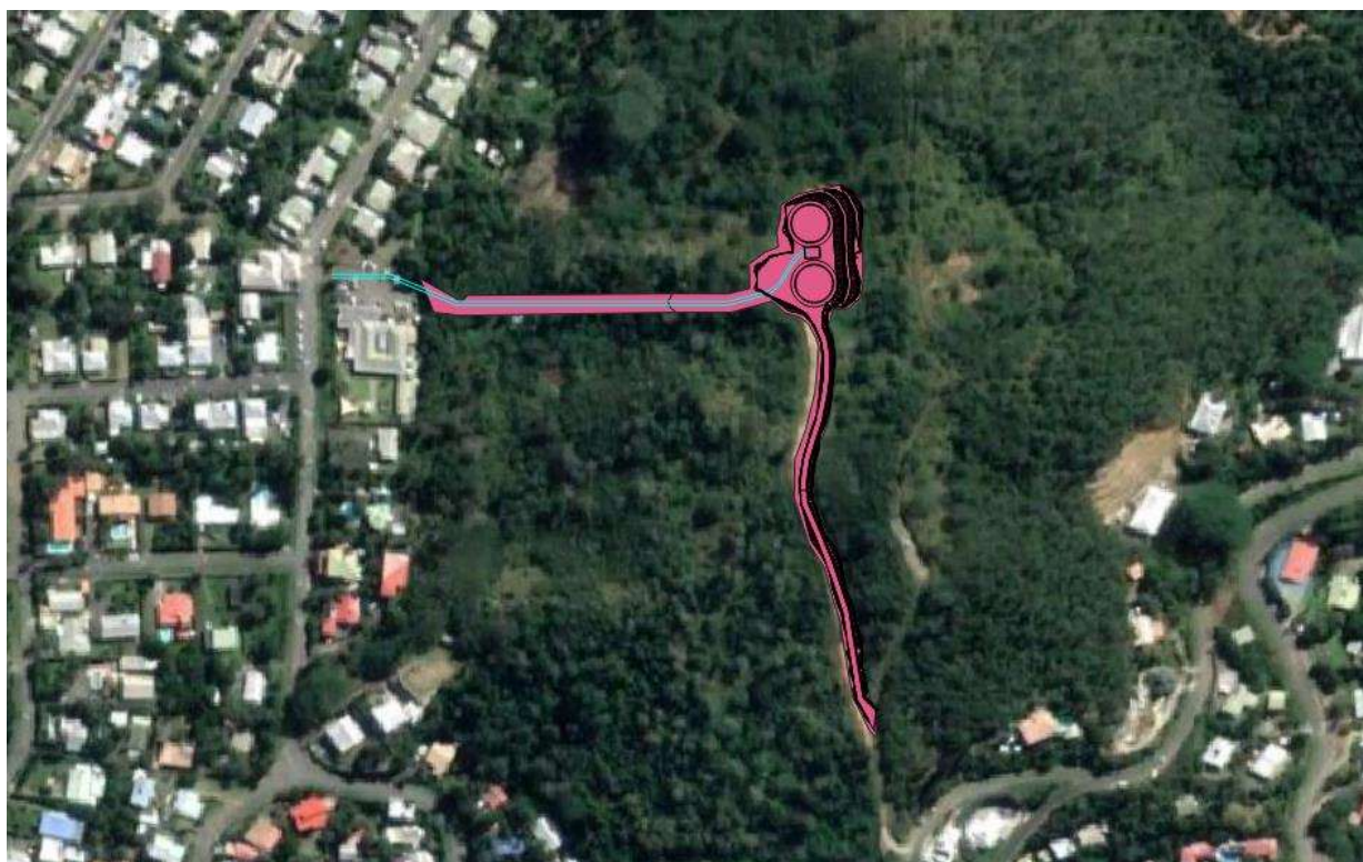
Figure 1 : emprise des travaux en déblai (en noir : le plan de terrassement / en rose : l'emprise du défrichement / bleu : conduites AEP)
