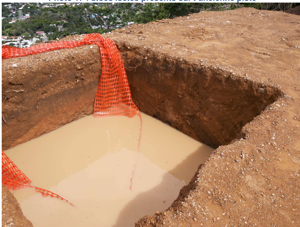
Photo 18 : fouille existante sur plate-forme OPT avec stratification visible
