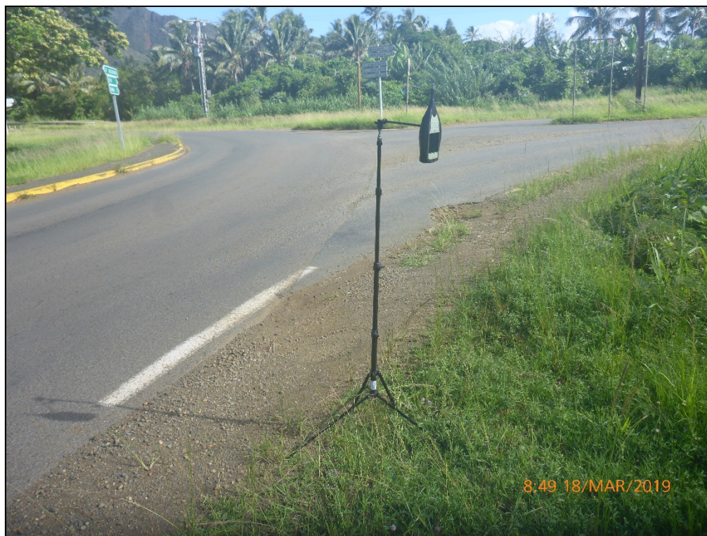
Figure 44 : Dispositif de mesure de bruit - Source : EMR, 2019.
