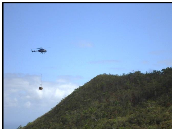
Photo 2 : Déplacement hélicoptéré d'une cuve.
