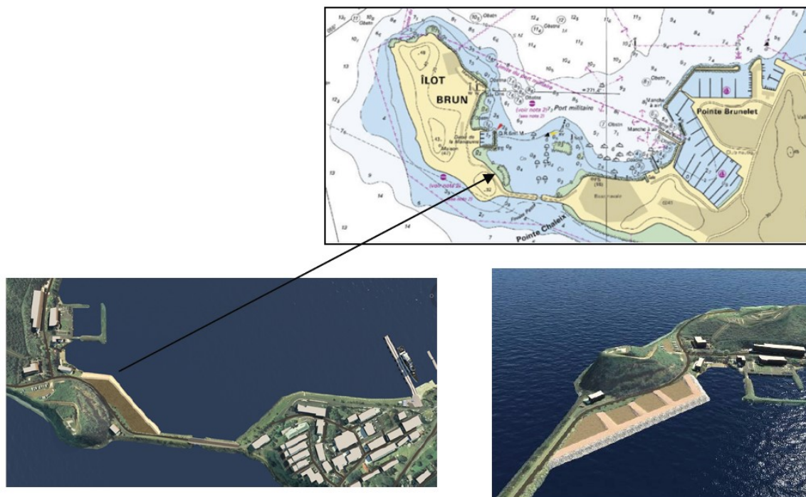
Figure 3 : Plan de principe du stockage des déblais en casier au Sud-est de l'îlot Brun
