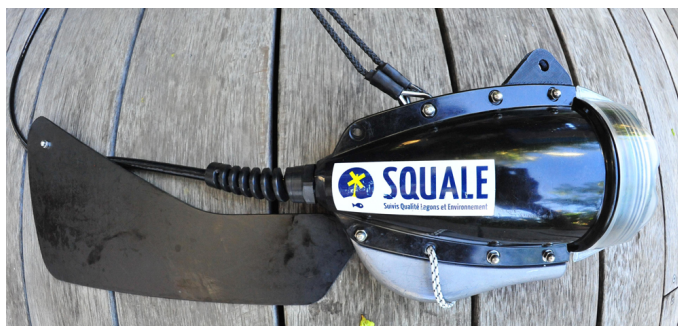
Figure 51 : Vue de la caméra tractée mise en œuvre
