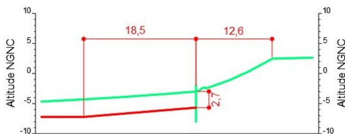
Figure 15 : Coupe au droit du raccordement entre le talus de la souille et le pied de talus en enrochement
