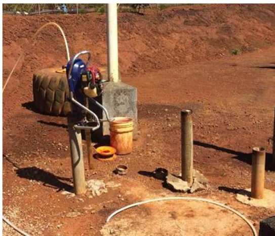
Pompage dans le piézomètre
