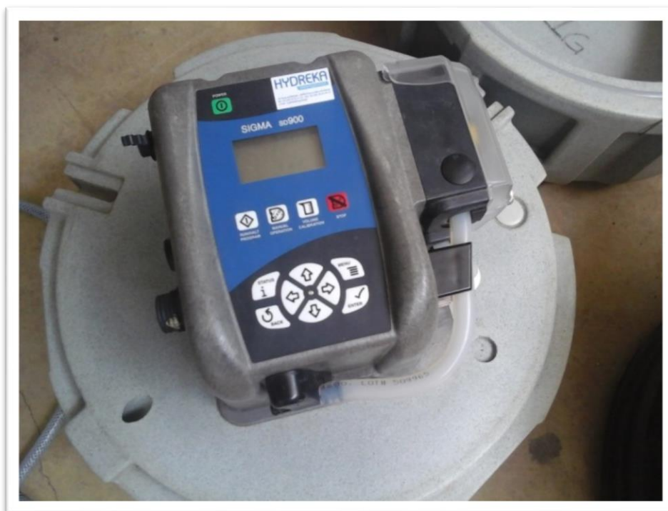
Tête de prélèvement pour programmation du bilan 24h
