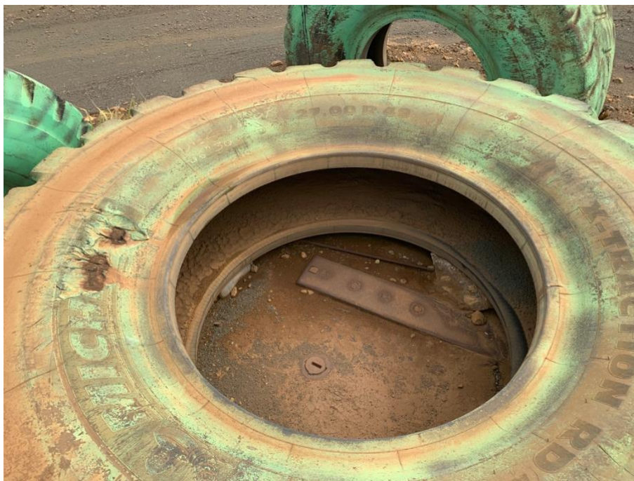
Figure 6 : Piézomètre P5. L'ouvrage est situé à ras du sol et est protégé par un pneu - Source : EMR, 2021.
