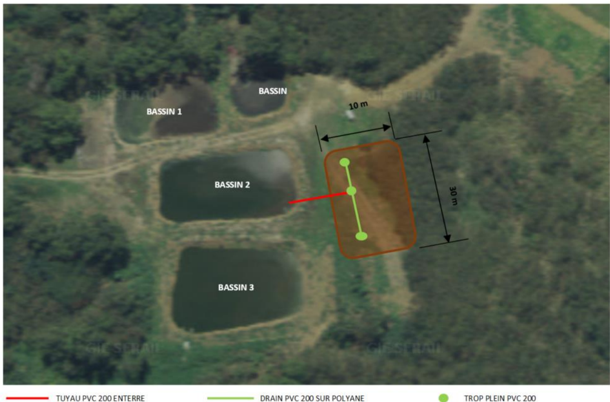
Figure 13 : Localisation de la plateforme de séchage des boues
