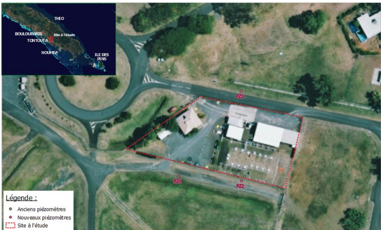
Figure 22 : Localisation des piézomètres sur le dépôt
