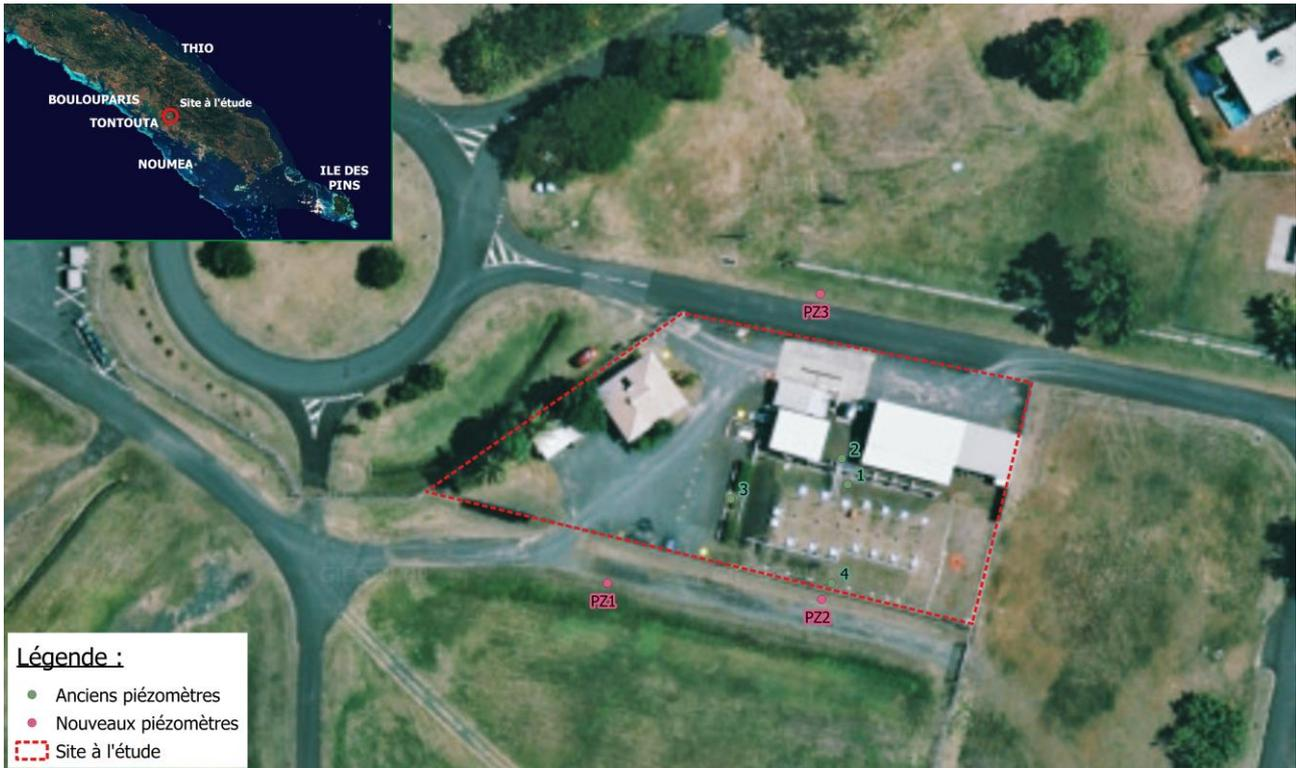
Figure 21 : Réseau piézométrique ancien et actuel du dépôt
