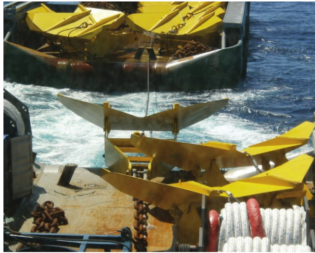
Figure 3 : Mise en place d'ancres de type STEVPRIS - STEVESHARK
