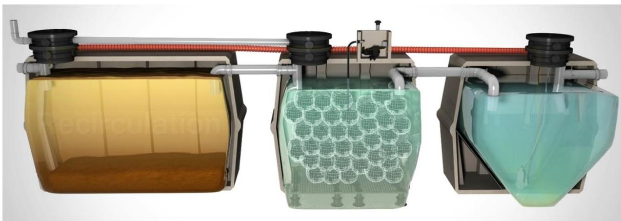
Les matières solides sont décantées et retenues dans le **décanteur primaire**. Dans ce compartiment, les eaux sont pré-traitées : les matières en suspension tombent dans la partie inférieure et sont partiellement assimilées par des bactéries anaérobies. Un chapeau solide se forme également à la surface. Les bactéries digèrent les matières organiques et liquéfient les matières solides.
