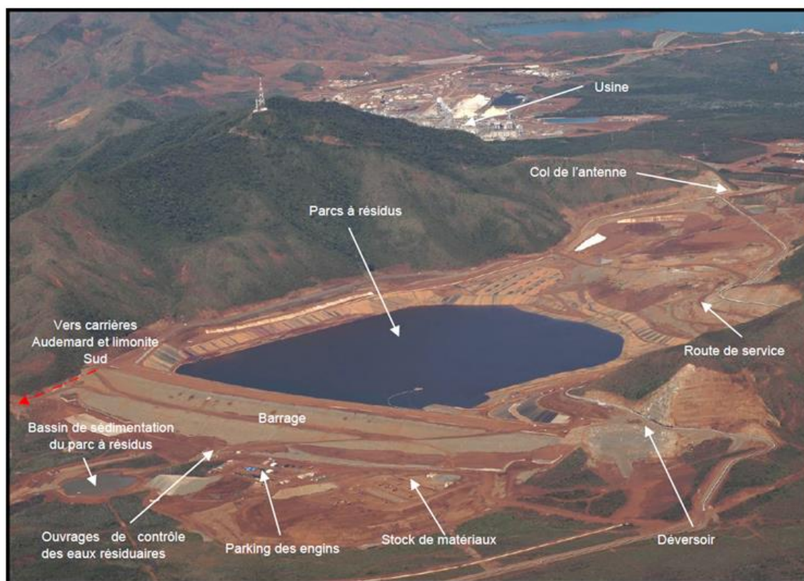
Illustration 27 – Vue aérienne du parc à résidus KO2 et de ses principales composantes relatives à la gestion des eaux (source : DAEM 2015 – Livret C – Volet A).
