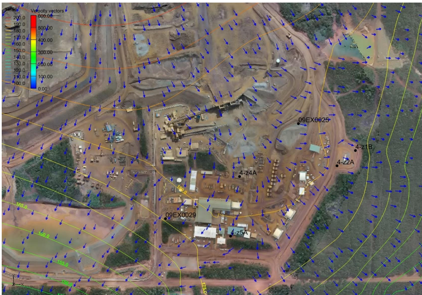
Illustration 9 : Aquitard latéritique : Carte piézométrique et directions d'écoulement dans le secteur de la FPP – Cycle hydrologique moyen (Les courbes piézométriques sont exprimées en m NGNC. Les points noirs représentent les piézomètres disponibles dans la zone d'étude. La couleur des flèches varie en fonction de la vitesse des écoulements) (source : VALE, 2017)
