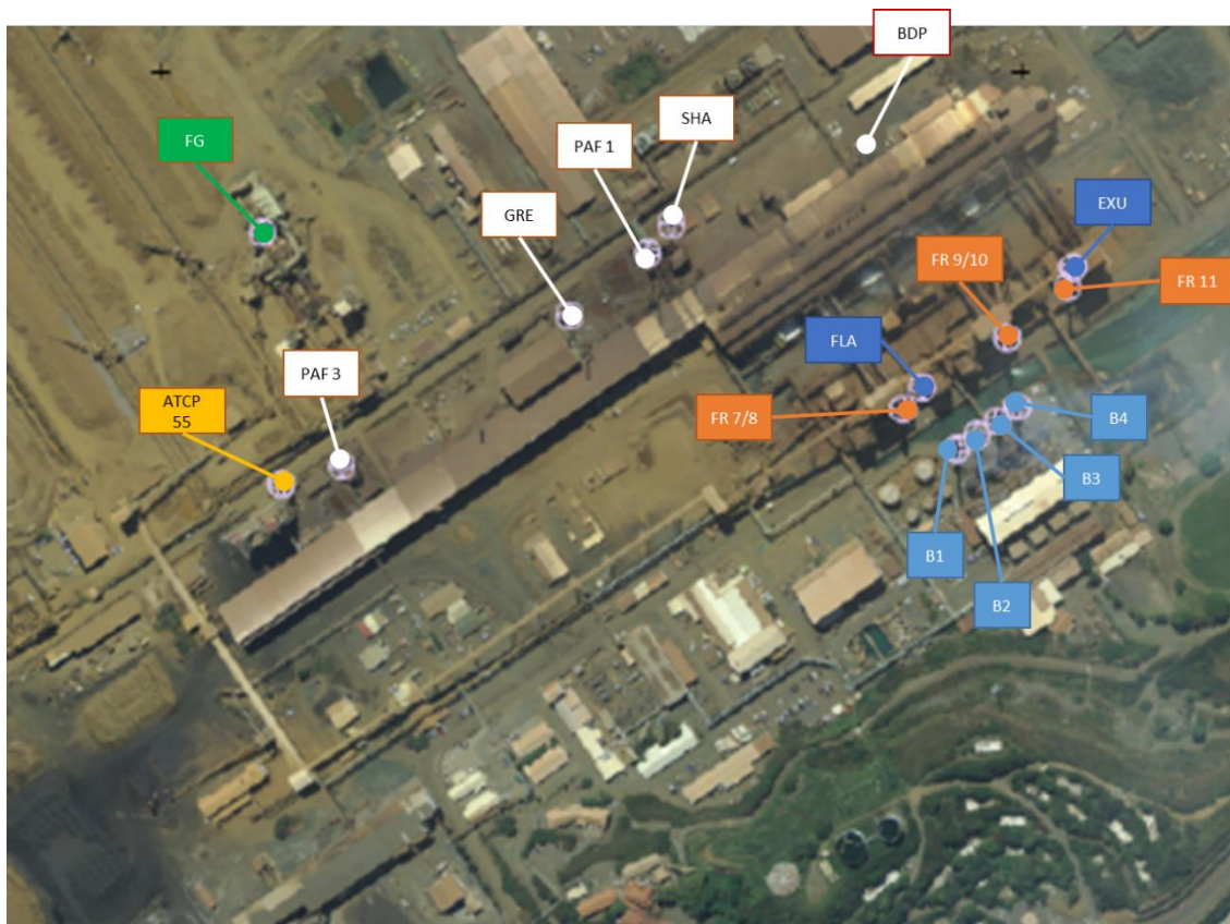
Figure 34 : Localisation des différentes cheminées du site industriel de Doniambo
