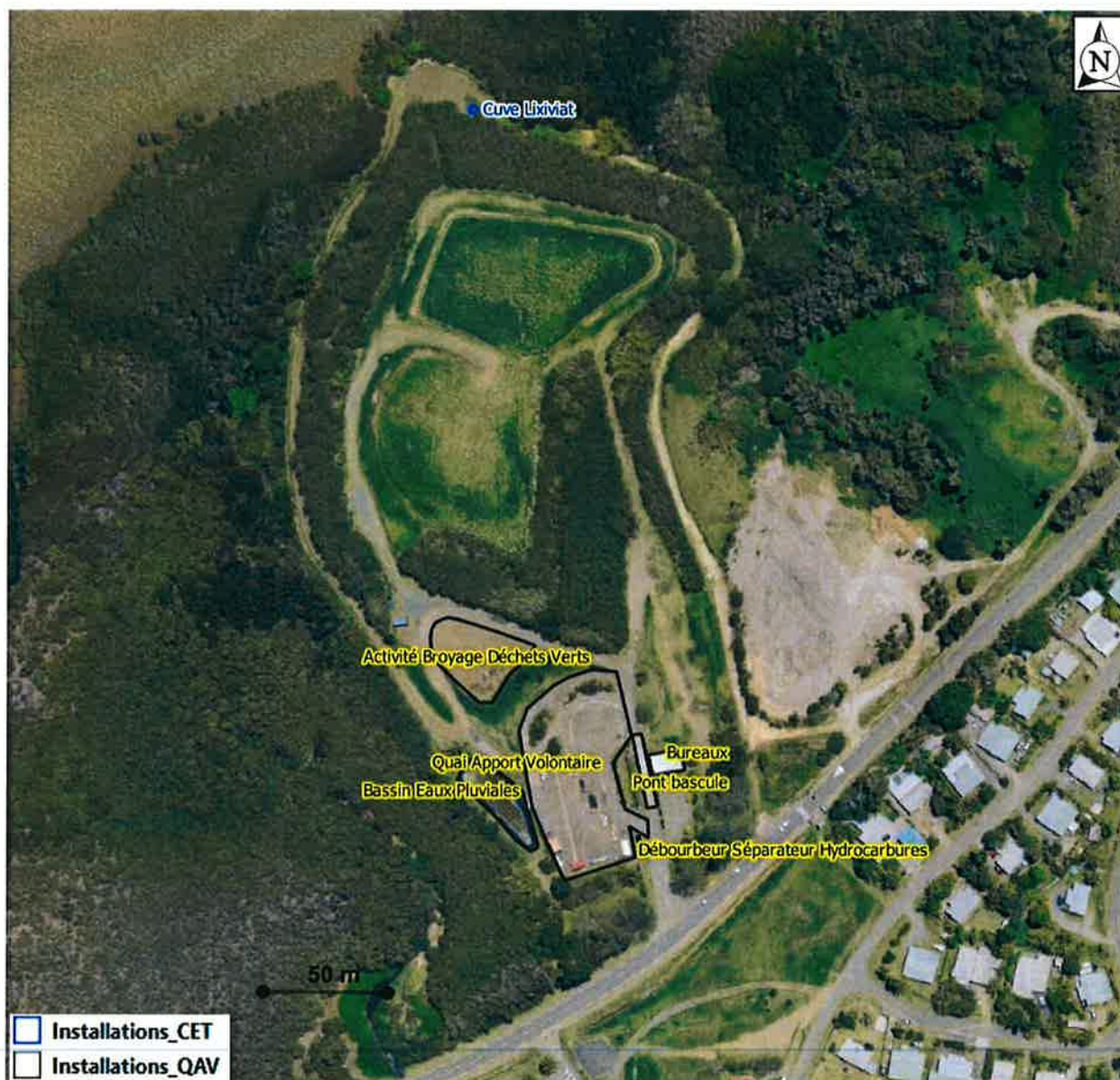
Figure 5 : Installations existantes au niveau de l'ancien CET et du QAV de la Coulée
