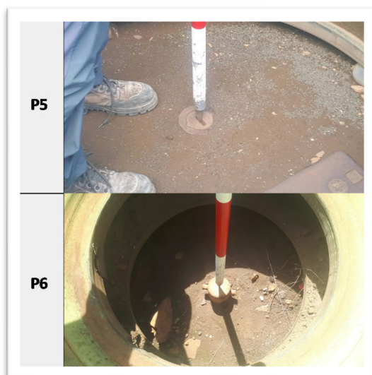
Figure 1 : Points de repère altimétrique des piézomètres.
