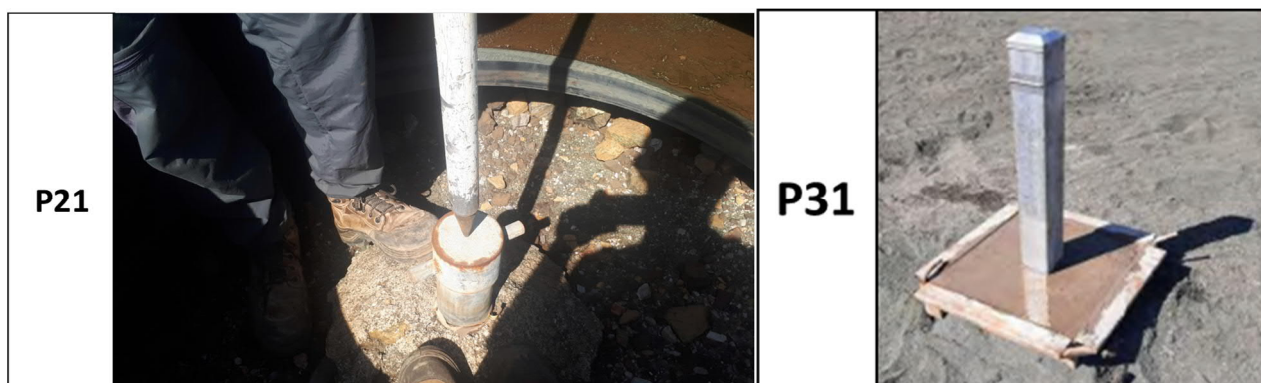
Figure 1 : Points de repère altimétrique du piézomètre.
