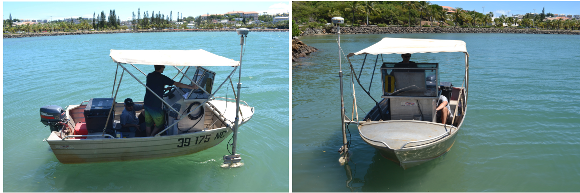
Figure 3 : Vue du porteur de petite dimension mis en œuvre pour l'acquisition bathymétrique
