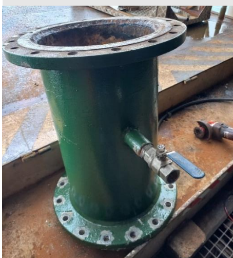
Figure 9. Modification des conduits d'eau de refroidissement afin de permettre le prélèvement de l'eau ciblée. Schématisation de la modification du piquage.
