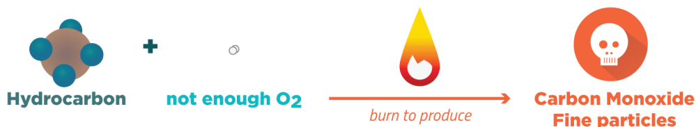
Figure 24. Schéma de la production de monoxyde de carbone
