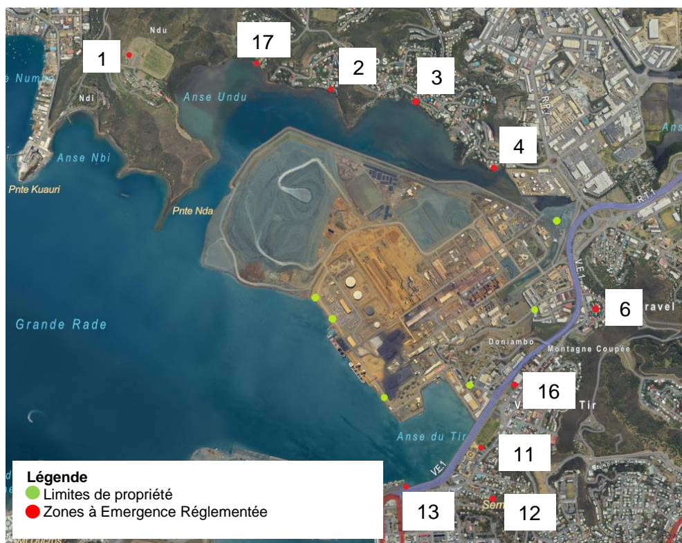
Figure 20 : Localisation des différents points de mesures des zones d'émergence règlementée (Fond image : Google)
