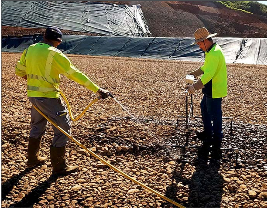
Photo 31 : Prospection par dipôle sur le massif de galets de rivière roulés. L'arrosage permet d'augmenter la sensibilité du signal reçu (faible conductivité électrique du galet sec).
