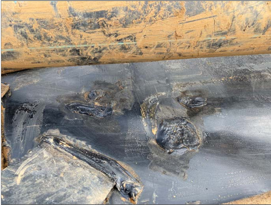
Photo 36 : 3 fuites de petite taille sont découvertes sous le drain de lixiviats. Des cailloux étaient placés entre la géomembrane et le géotextile, et ont perforé la géomembrane sous le poids du remblais.
