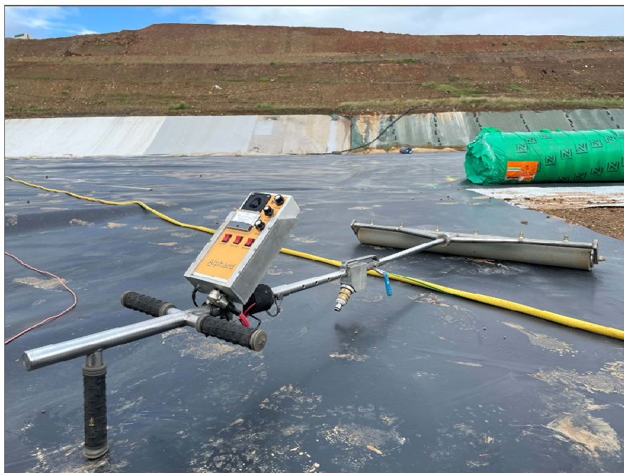
Photo 23 : Équipement de jet d'eau dans le casier E2
