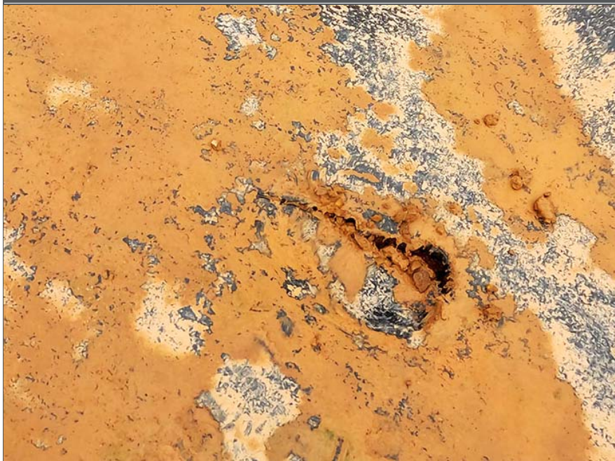
Photo 34: Perforation importante repérée à l'endroit de l'excavation. Le géotextile et la géomembrane sont perforés, indiquant que le problème est survenu après la prospection au jet d'eau.
