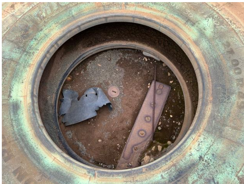
Figure 6 : Piézomètre P5. L'ouvrage est situé à ras du sol et est protégé par un pneu - Source : EMR, 2021.
