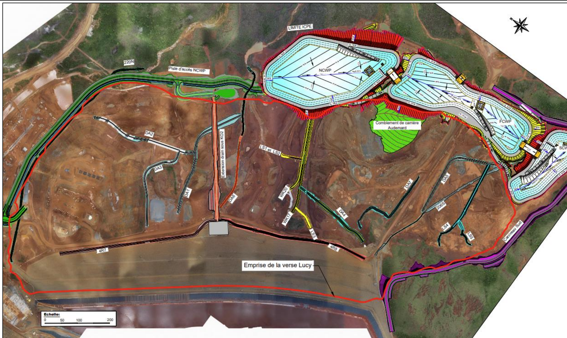
Figure 11 : Vue en plan des ouvrages projetés en zone aval dans le cadre des travaux préparatoires préalables à la mise en verse
