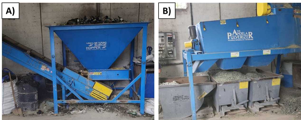
Figure 7 : Photos de l'unité de broyage : A) trémie et convoyeur, B) broyeur et cribles
