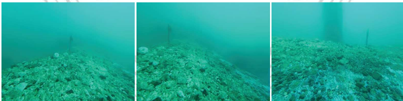
Pieu n°A-11 : Merlon bien formé (soufre, charbon, calcaire)
