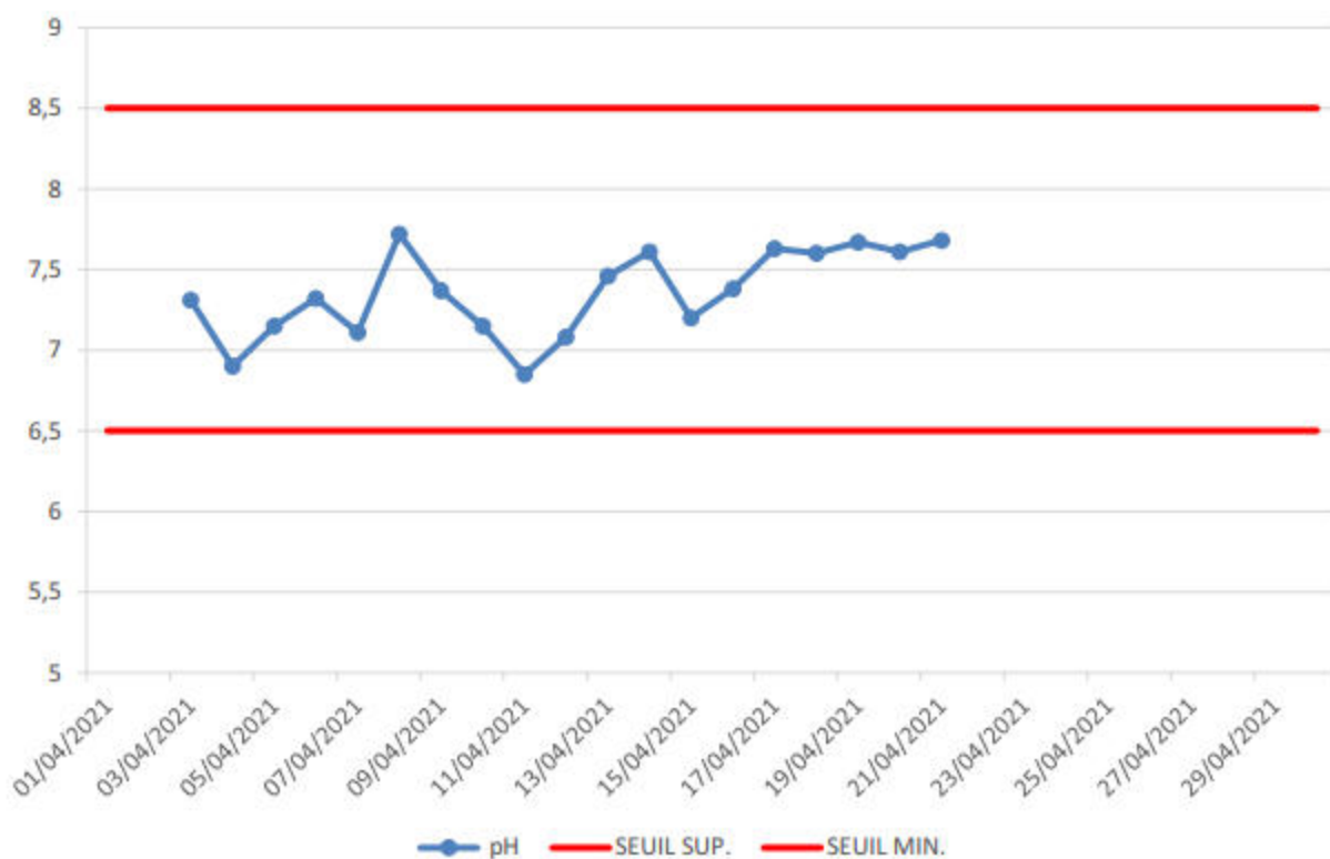
Mesure de pH en continu - Rejets eaux issues du parc à charbon (6-IP3)
