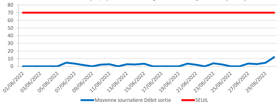
Mesure de débit (m 3 /h) en continu - Rejets effluents pluviaux (6-IP2)
