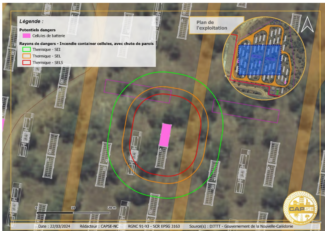
Figure 47 : Incendie conteneur avec chute de parois à proximité du poste de livraison au centre du site
