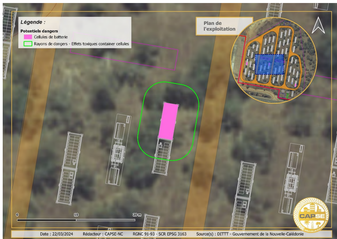
Figure 53 : Effets toxiques d'un incendie de conteneur batterie à proximité du poste de livraison au centre du site
