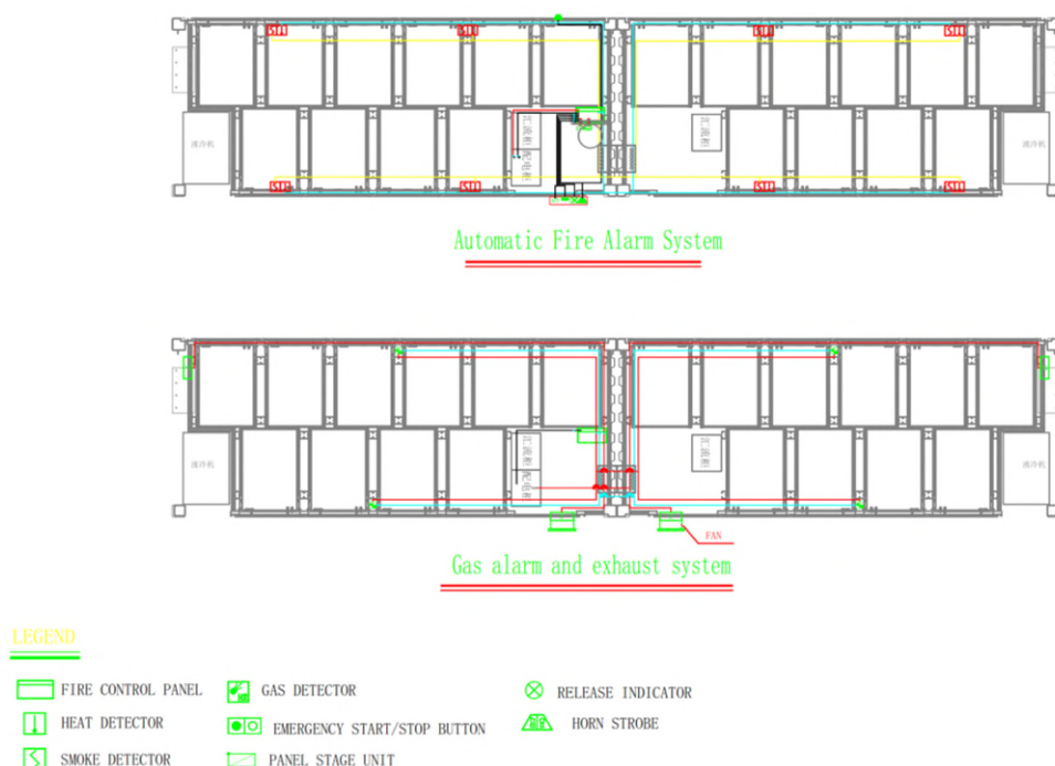
Figure 26 : Schéma d'implantation des équipements de détection d'incendie
