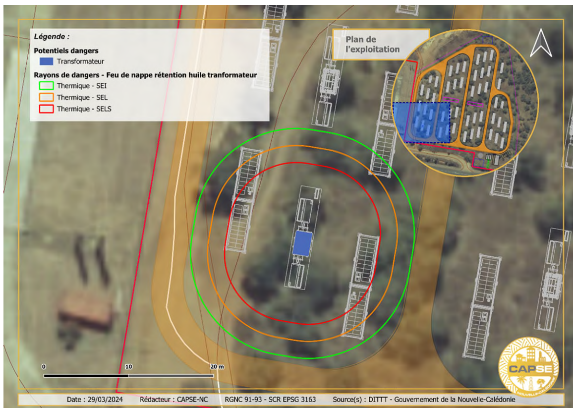
Figure 49 : Incendie d'un transformateur à proximité de la limite de propriété sud-ouest du site
