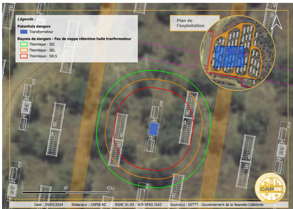
Figure 50 : Incendie d'un transformateur à proximité du poste de livraison au centre du site
