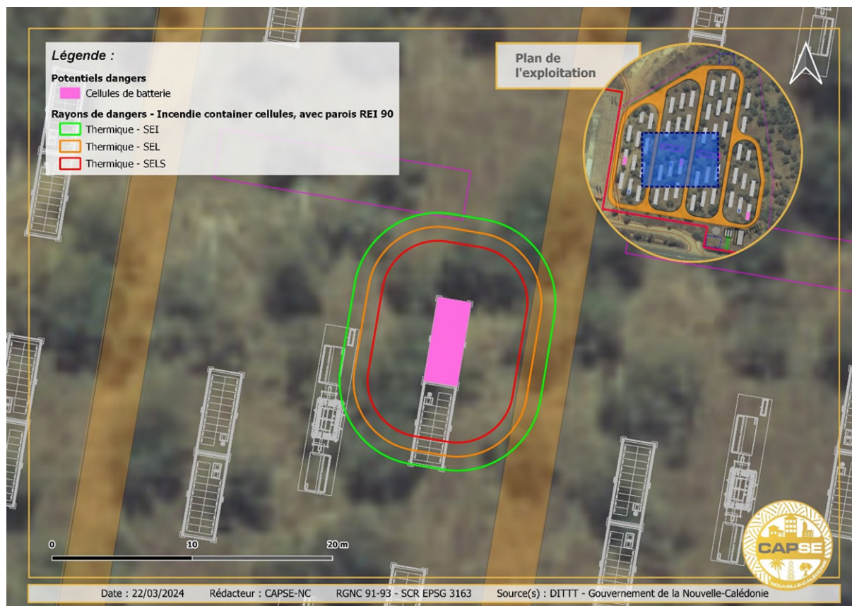
Figure 42 : Incendie conteneur avec paroi REI 90 à proximité du poste de livraison au centre du site
