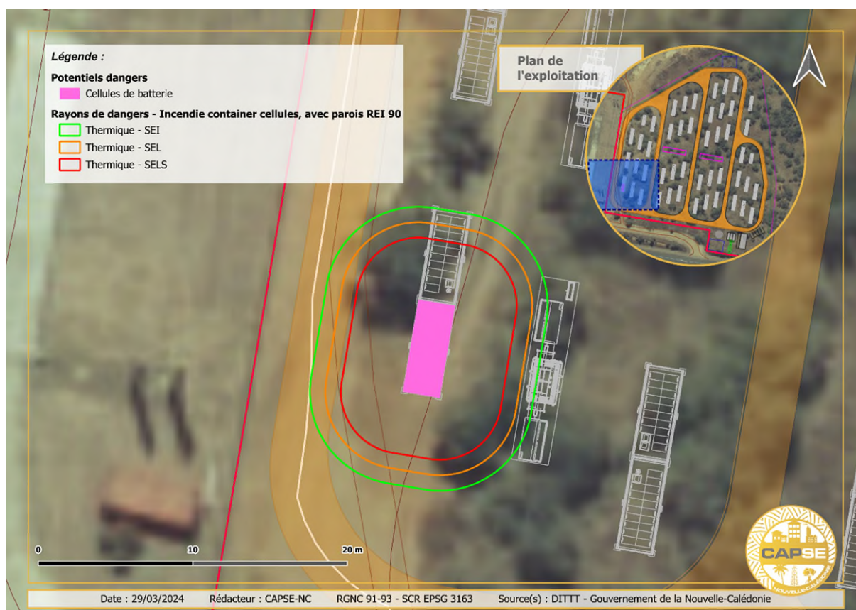
Figure 41 : Incendie conteneur avec paroi REI 90 à proximité de la limite de propriété ouest du site
