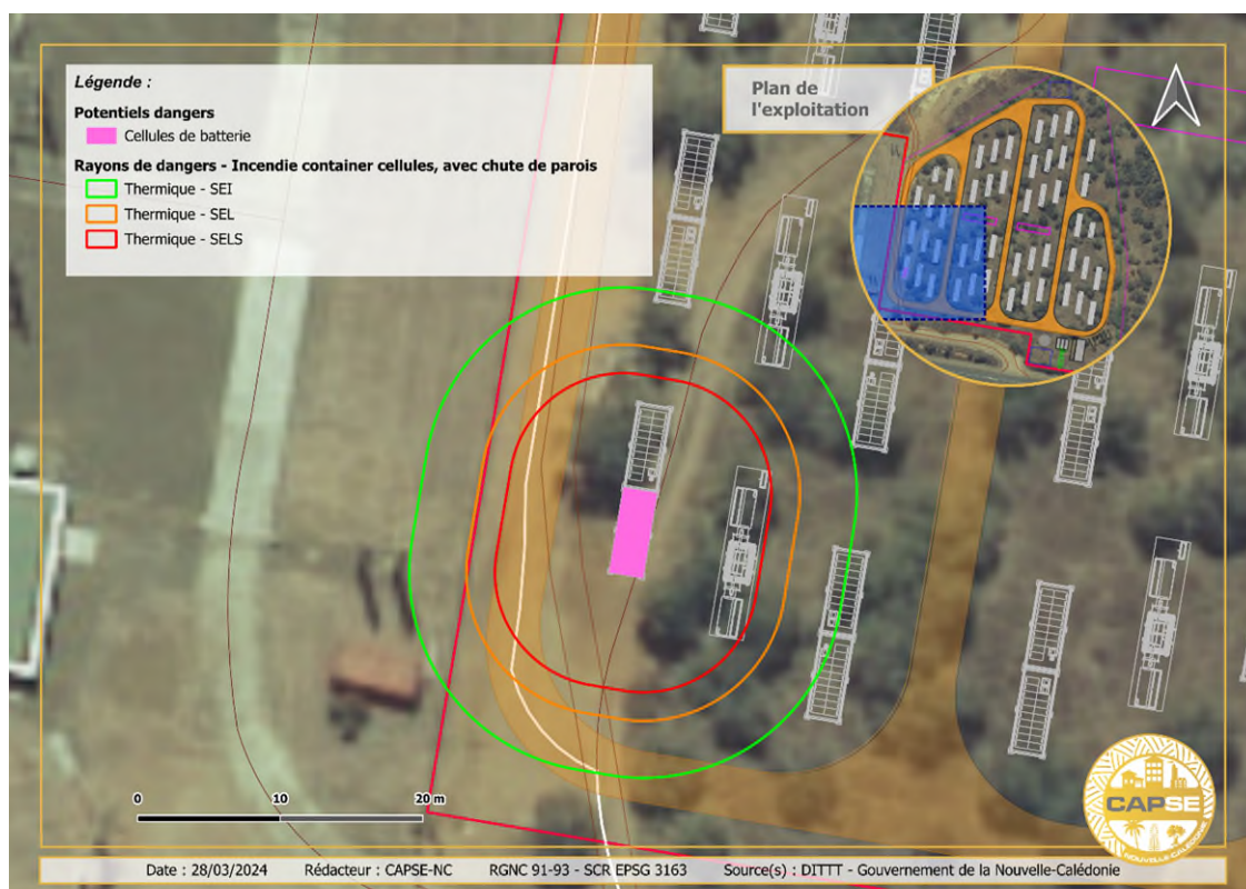
Figure 46 : Incendie conteneur avec chute de paroi à proximité de la limite de propriété ouest du site
