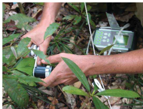
Figure 3 : Mesure de fluorescence chlorophyllienne avec un fluorimètre portatif
