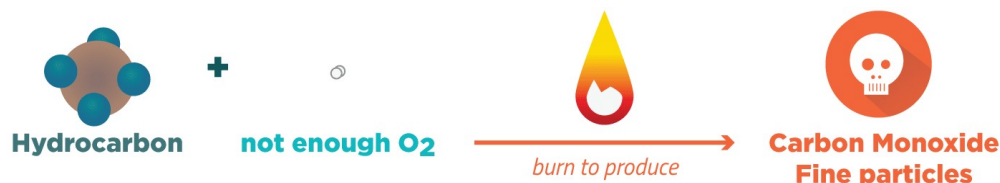
Figure 31. Schéma de la production de monoxyde de carbone
