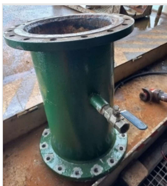
Figure 5. Modification des conduits d'eau de refroidissement. Schéma de la modification du piquage.
