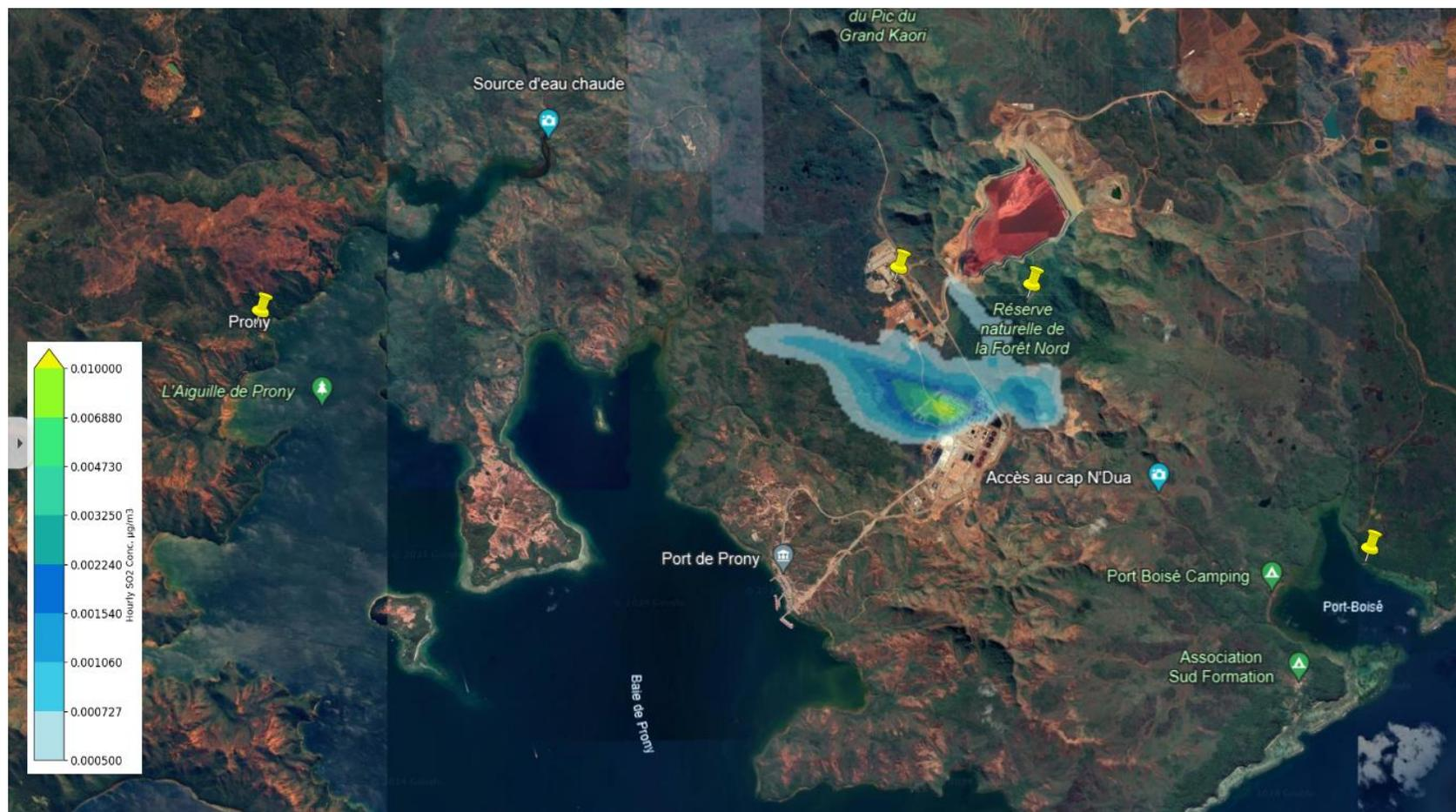
Figure 14 : Modélisation de la dispersion du SO<sub>2</sub> induit par les émissions de la chaudière 305-1010
