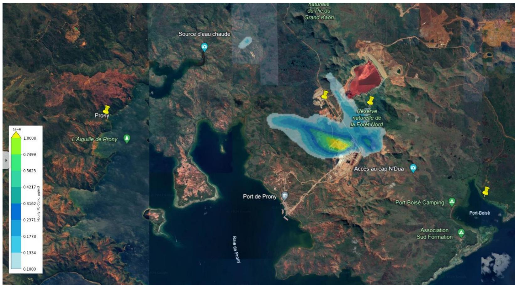
Figure 12 : Modélisation de la dispersion du plomb induit par les émissions de la chaudière 305-1010
