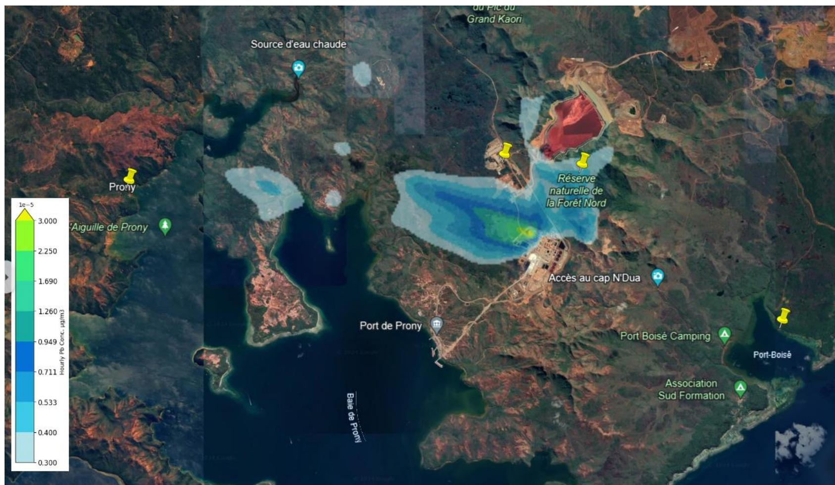
Figure 13 : Modélisation de la dispersion du plomb pour l'ensemble des sources d'émission prises en compte
