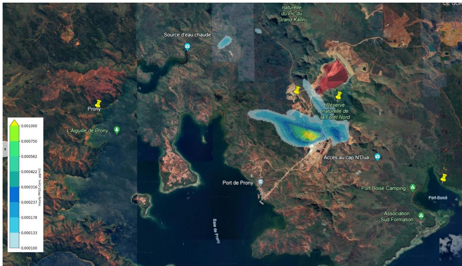
Figure 10 : Modélisation de la dispersion des PM<sub>10</sub> induites par les émissions de la chaudière 305-1010
