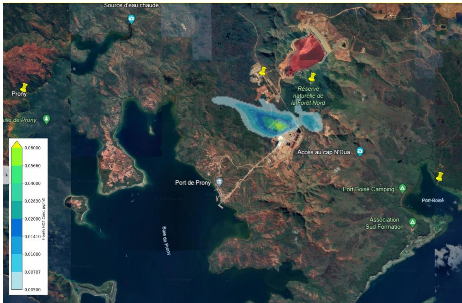
Figure 8 : Modélisation de la dispersion du NO2 émis par la chaudière 305-1010
