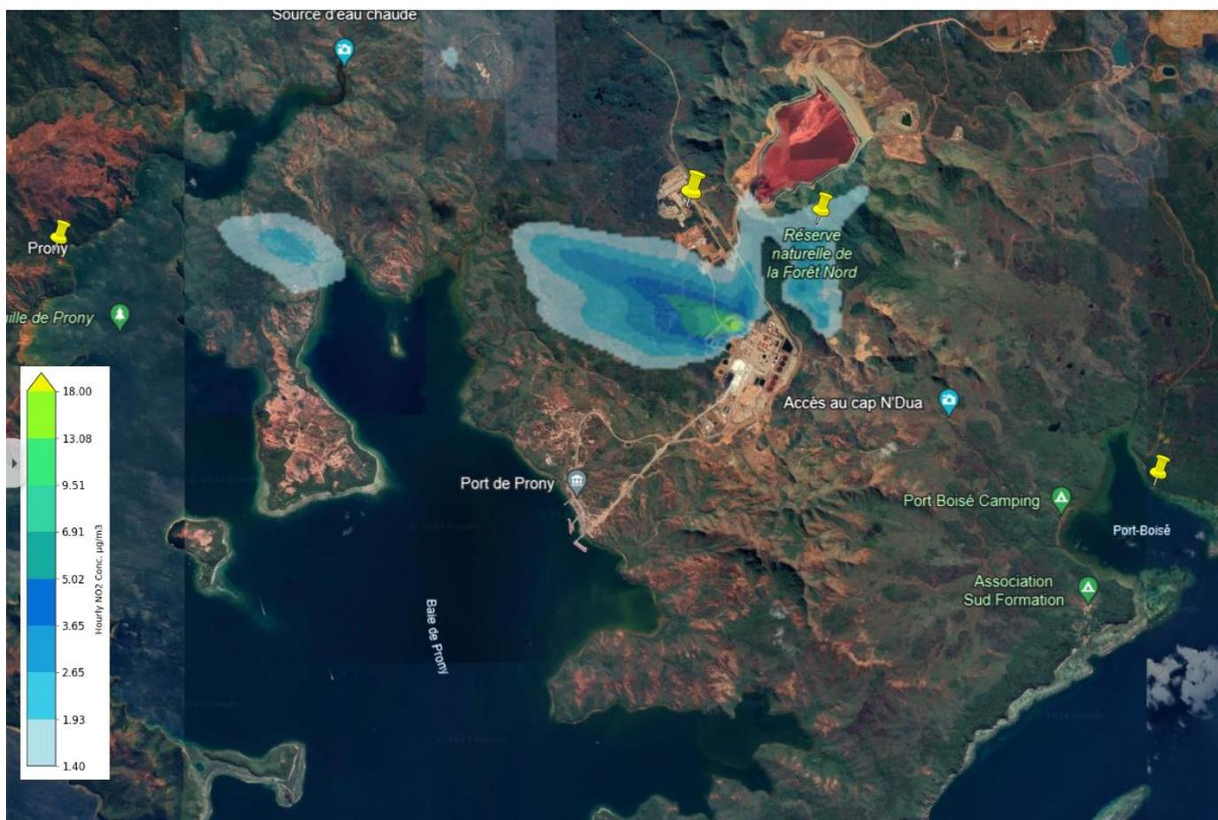
Figure 9 : Modélisation de la dispersion du NO2 pour l'ensemble des sources d'émission prises en compte
