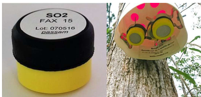
Figure 1: Dispositif de mesures passives du SO 2 par tubes Passam Ag
