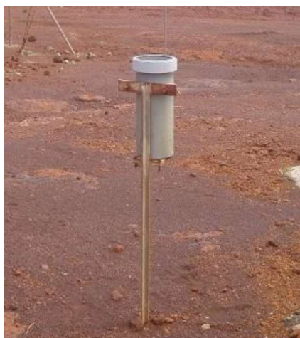
Figure 4 : Dispositif de collecte des eaux de pluie
