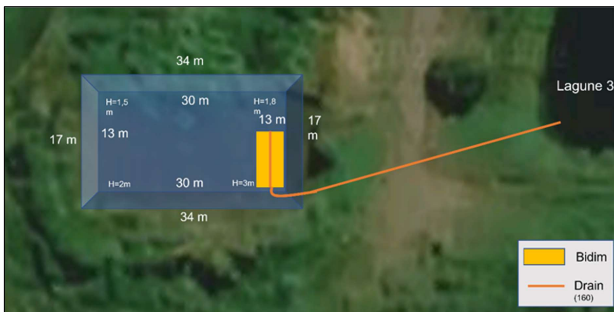
Figure 1 : Dimensions du lit de séchage (relevés Juin 2023)
