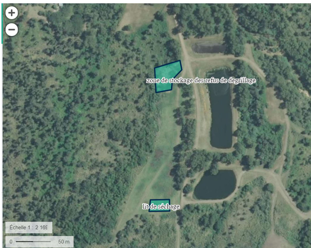
Figure 6 : Zones de stockage des matières à épandre
