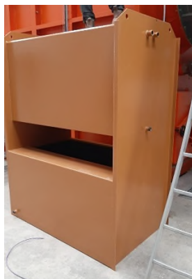
Figure 5 : cuve tampon de 1000 litres de gazole
