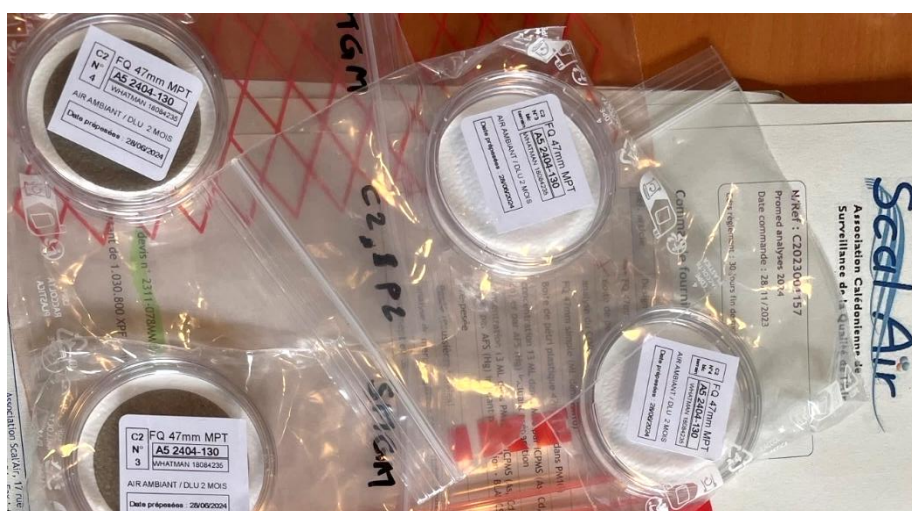
Figure 11 : Exemple de filtres blancs et échantillons après prélèvement et avant envoi en laboratoire pour la pesée des particules fines PM10 et l'analyse des métaux
