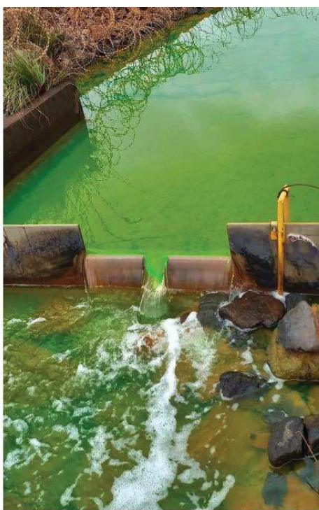
Figure 11 : Traceur observé au niveau du drain 4R8
