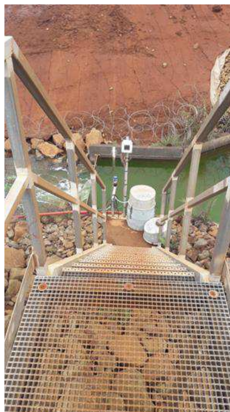
Figure 10 : Préleveur automatique installé sur le drain 4R8
