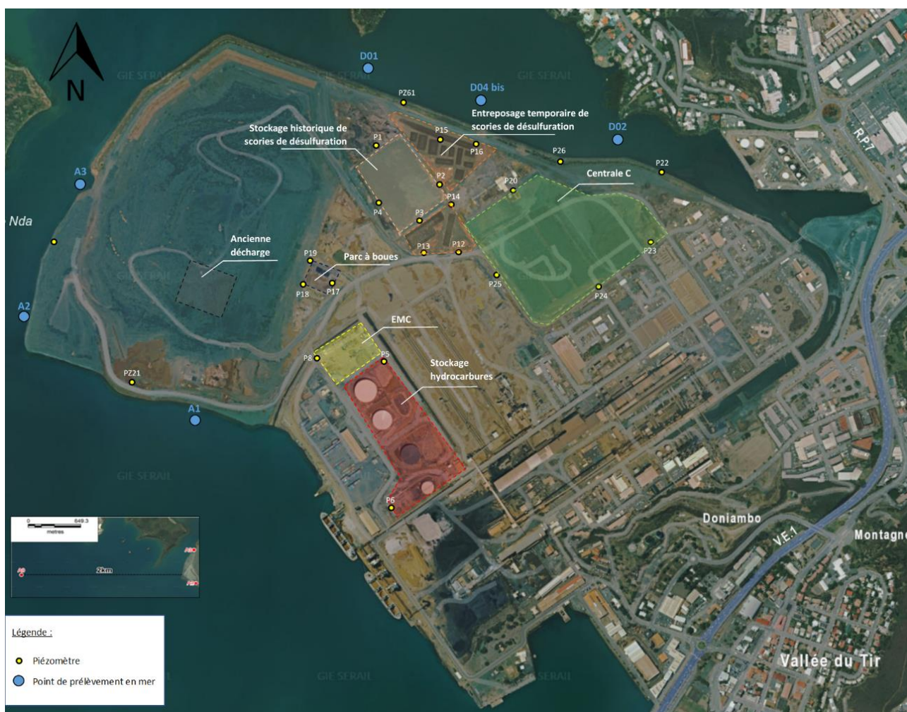
Figure 44: Localisation des piézomètres et des points de prélèvement en mer pour le suivi des eaux souterraines du site de Doniambo
