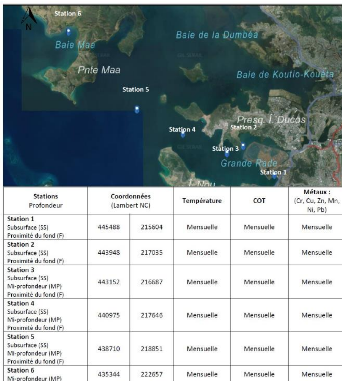
Figure 41: Cartographie des points de prélèvements en mer et description du programme de suivi mensuel de la qualité de l'eau
