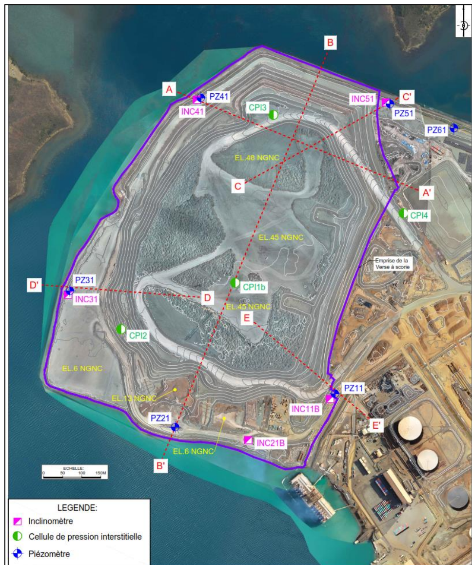
Figure 7 : Implantation du dispositif d'instrumentation de la verse à scories en décembre 2024
