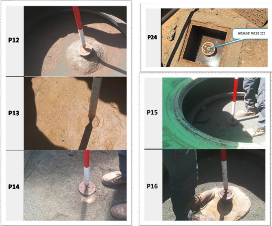
Figure 1 : Points de repère altimétrique des piézomètres.
