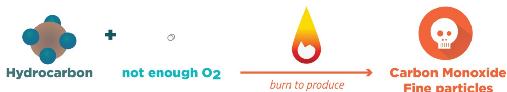
Figure 19. Schéma de la production de monoxyde de carbone
