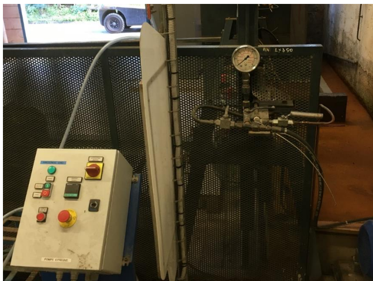
POMPE du banc d'épreuve : Pression maxi d'utilisation 450 bars
