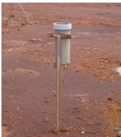
Figure 4 : Dispositif de collecte des eaux de pluie
