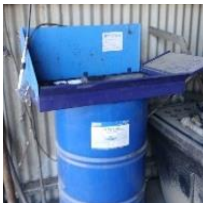
Figure 7 : Fontaine de lavage existante
